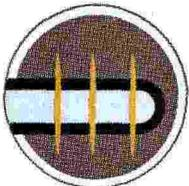
**3** Vengono fatte esplodere delle cariche all'interno di un perforatore creando piccoli fori nello scisto
